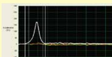
プロテクターに50 ジュールの力を加え、プロテクターを通して伝達された力（加速度）を図り、( k N : キロニュートン ) の数値を検証する。(室温 23°C / 湿度 50%) 数値が低いほど、衝撃吸収力が高く、より安全性が高いプロテクターと言える。
