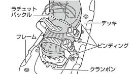
○ラチェットバックルを引き上げ締め付けます。
