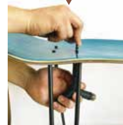
④ スケボーレンチでネジを しっかりと固定する。
